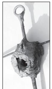
■ Fig. 32 Moule en argile-crottin pour tampon.
